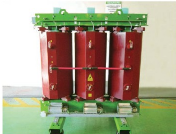
Transformador Encapsulado elevador YNd11, con ventilación forzada
